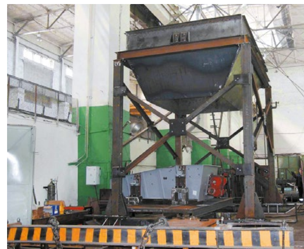
ПСК-52 Модуль питания / PSK-52 Feeding module
