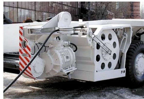
Кабельный барабан / Cable drum
