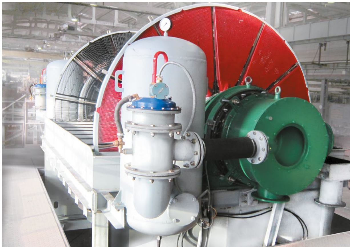
Дисковый вакуум-фильтр ДОО-63 с металлическими и пластиковыми секторами/ Disc vacuum filters DOO-63 with metal and plastic sectors
