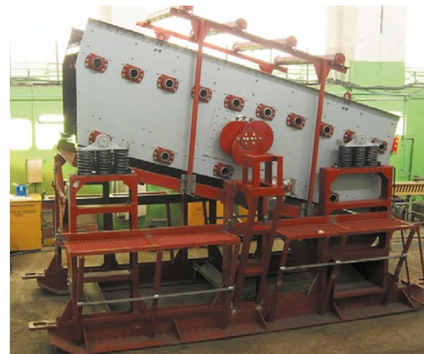
ПСК-52 Модуль грохочения / PSK-52 Screening module
